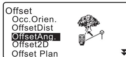
5. Haga puntería en el punto desplazado y pulse **[MEAS]** (medir) en la primera página de la pantalla del modo de observación para comenzar la medición.
