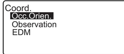
4. En <Coord>, seleccione «Observation» (observación). Si pulsa **[MEAS]** (medir), comenzará la medición, y se mostrará el valor de las coordenadas del blanco. Pulse **[STOP]** (detener) para dejar de medir.
