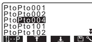
6. Repita los pasos 4 y 5 hasta haber medido todos los puntos. Los puntos incluidos en un área limitada se observan en sentido horario o antihorario. Una vez observados todos los puntos conocidos necesarios para calcular la superficie del área, aparecerá **CALC**.
