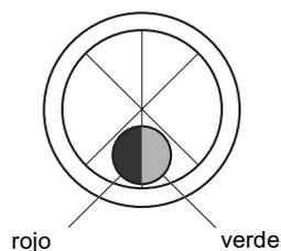
7. Mueva la parte superior del instrumento ligeramente mientras mira por el anteojo; mida el ángulo horizontal de la posición que cambia sólo a verde desde ambos colores (rojo y verde) de los colores de la luz guía que se reflejan en el prisma.
