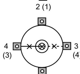
7. Gire la parte superior del instrumento para revisar el ajuste. El punto topográfico debería continuar centrado en el retículo. Si fuera necesario, repita el ajuste.
