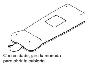
4. Coloque las dos pilas (R03/AAA). La dirección de las pilas viene indicada en el compartimiento de las pilas.
