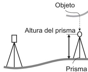
2. Después de introducir la altura del prisma, obsérvelo con precisión.
