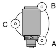
5. Ponga a 0° el ángulo de inclinación con los tornillos A y B de nivelación del pie para la dirección X y el tornillo C para la dirección Y.
