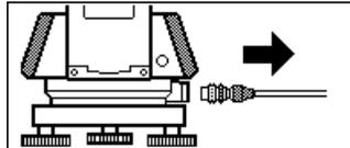
Si el cable de la impresora está conectado mientras se realiza la medición, ésta no se podrá llevar a cabo correctamente. El SET lo indicará mostrando la pantalla anterior y emitiendo un pitido. En cuanto retire el cable, regresará a la pantalla anterior.
