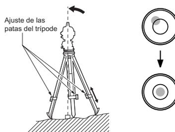
3. Centre la burbuja del nivel tubular. Afloje el tornillo de apriete horizontal para girar la parte superior del instrumento hasta que el nivel tubular esté paralelo a una línea situada entre los tornillos A y B de nivelación del pie.
