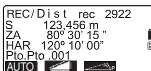
6. Pulse **{ESC}** para salir de la medición y volver a <REC>.
