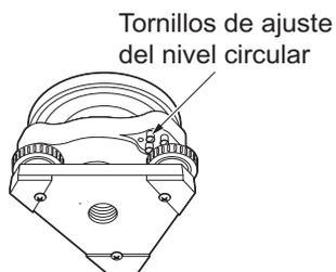
4. Apriete los tornillos de ajuste hasta que la tensión de los tres tornillos sea igual para alinear la burbuja en medio del círculo.
