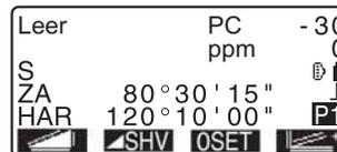
Si aparece en pantalla el mensaje "Fuera de rango", el sensor de inclinación está indicando que el instrumento no está nivelado. Nivele el instrumento otra vez y aparecerán en pantalla el ángulo horizontal y el vertical.
