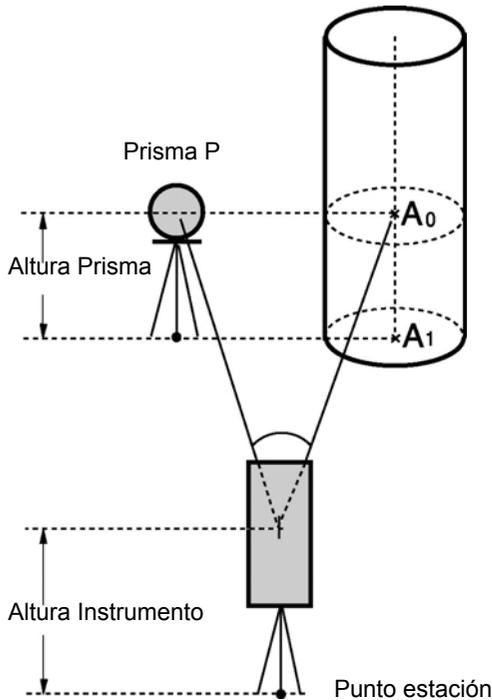
Al realizar la medición de las coordenadas del punto  $A_1$  desde el suelo, coloque la altura del instrumento y la altura del prisma.
