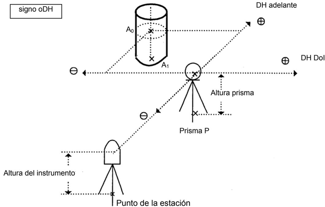
Cuando se midan coordenadas del punto A<sub>1</sub> desde el suelo: Introduzca altura de instrumento / altura del prisma.
